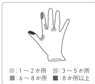
図4: 手袋装着中に、手袋の破損が確認された部位
